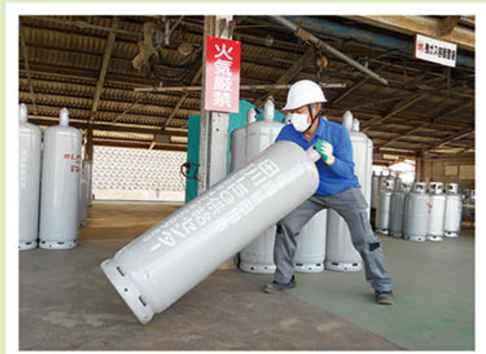
3 ガス流出防止の為に転倒した容器を起す
